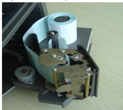
(4) Uvolněný papír vložte do odvíjecího zařízení
