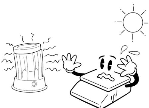
Nevystavujte váhu náhlým změnám teplot ani dlouhodobému přímému působení slunce nebo jiných zdrojů intenzivního tepelného záření.
