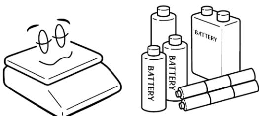
Není-li váha delší dobu používána, uložte ji s plně nabitym akumulátorem. Mohlo by dojít k jeho poškození nebo zničení.
